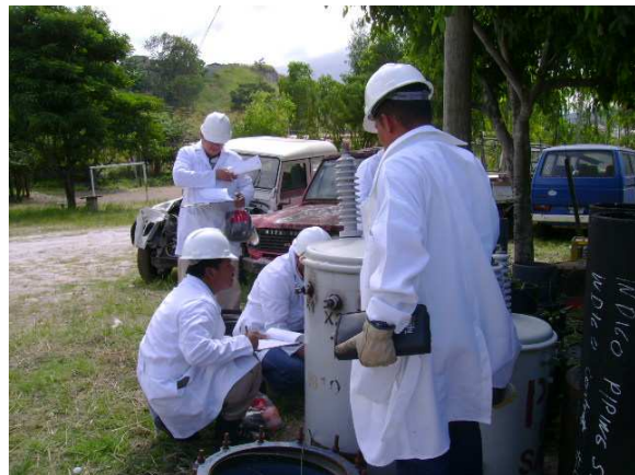
Imagen 1. Transformadores de distribución en desuso y desmantelados. Inventario Nacional de PCBs, PNI-COPs, Honduras, 2008.
